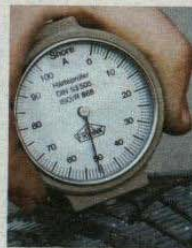
Ein spitzer Metallstift ermittelt die Elastizität
